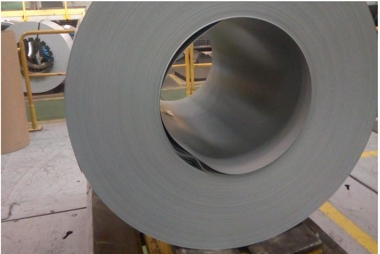
Рис. 3.7. Пример дефекта «птичка» №2
