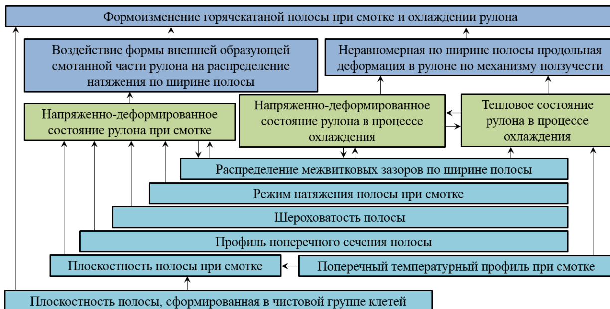
Рис. 4.17. Факторы, определяющие процесс формоизменения полосы при смотке и охлаждении рулона
